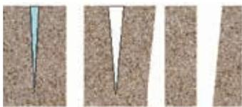
缝水填充的裂隙 水结冰膨胀 岩石破碎
